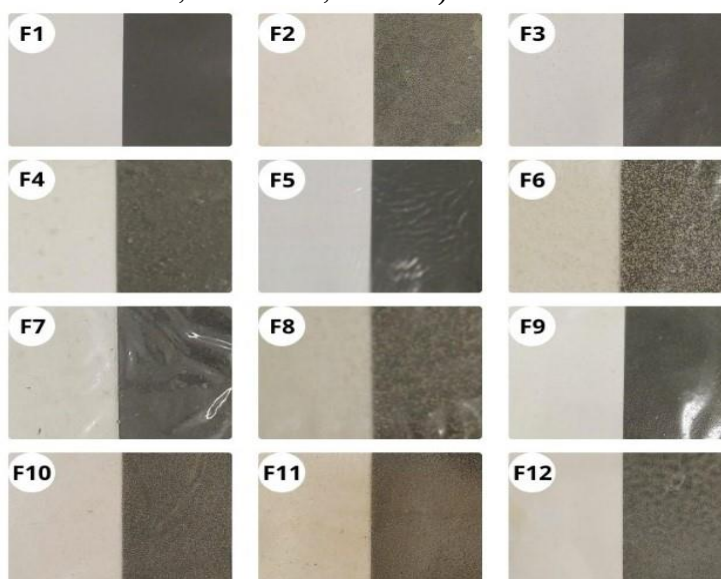
Figura 14 - Filmes produzidos a base de alginato de sódio, cera de abelha e polpa de juá em diferentes concentrações. F1(100% ALG/GL); F2(60%ALG/GL+40%CE); F3(60%ALG/GL+40%JUÁ); F4 (80%ALG/GL+20%CE); F5(80%ALG/GL+20%JUÁ); F6(60%ALG/GL+20%CE+20%JUÁ); F7(86,66%ALG/GL+ 6,66%CE+6,65%JUÁ); F8(66,66%ALG/GL+26,6%CE+6,65%JUÁ); F9 (66,66%ALG/GL+6,66%CE+26,65%JUÁ); F10/F11/F12 (73,33%ALG/GL+13,33%CE+13,34%JUÁ).
