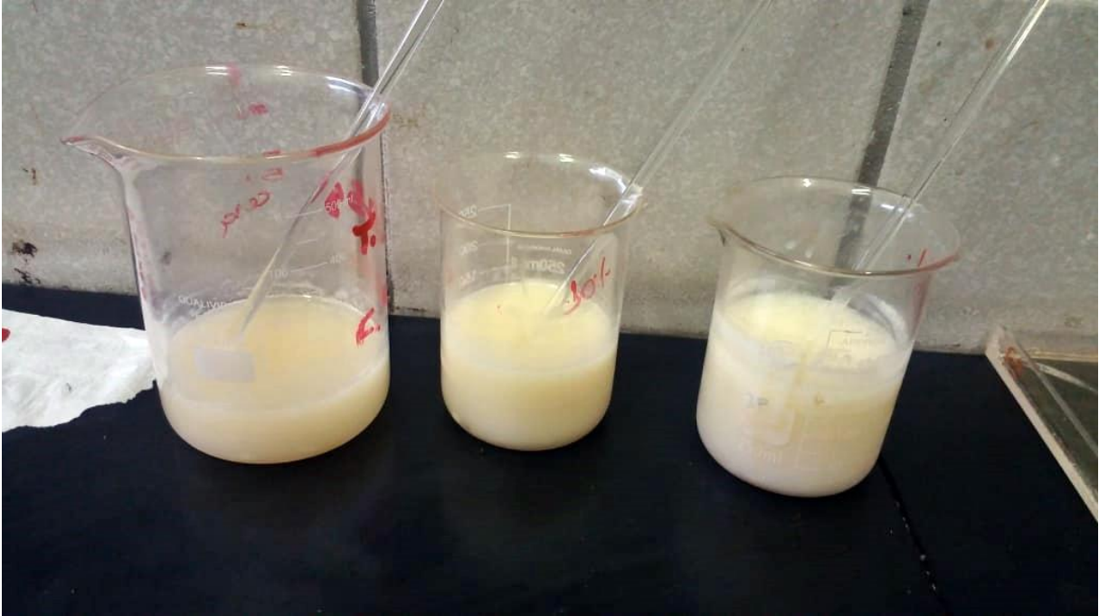
Figura 2. Misturas de alginato de sódio e cera de abelha após 10 dias de descanso, aquecimento e agitação.
