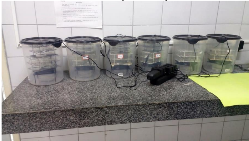
Figura 5. Sistemas simulando microclimas para obtenção de isotermas de sorção de água
