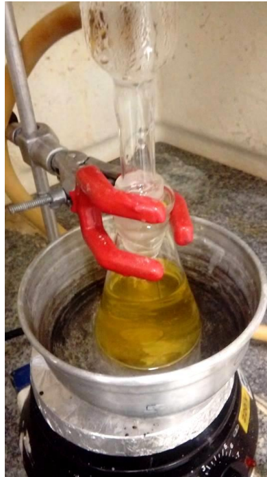
Figura 5. Saponificação da cera de abelha em aparelho de refluxo.
