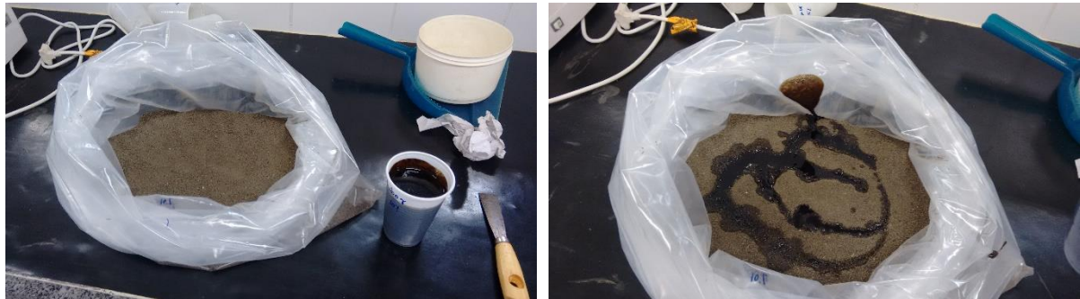
Figura 8. Contaminação das amostras de solo com petróleo em saco plástico para homogeneização.
