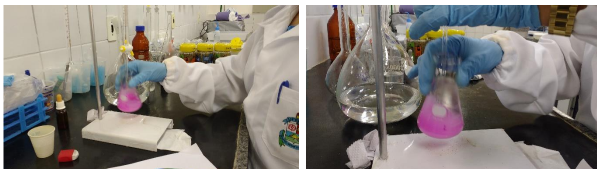
Figura 10. Titulação da solução de NaOH contendo o CO 2 produzido nos respirômetros, titulados com HCl, utilizando fenolftaleína como indicador.
