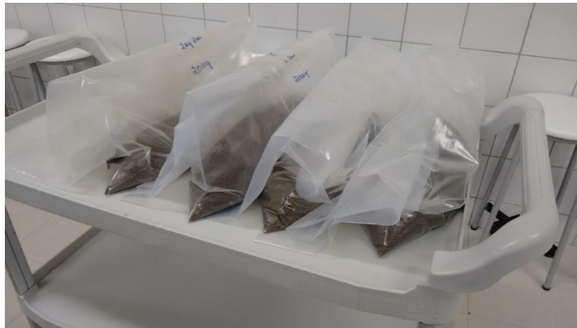
Figura 7. Amostras de solo pesadas com 2,0 kg cada em sacos plásticos para contaminação com petróleo nas respectivas porcentagens de 0, 1, 3, 5 e 10 %.
