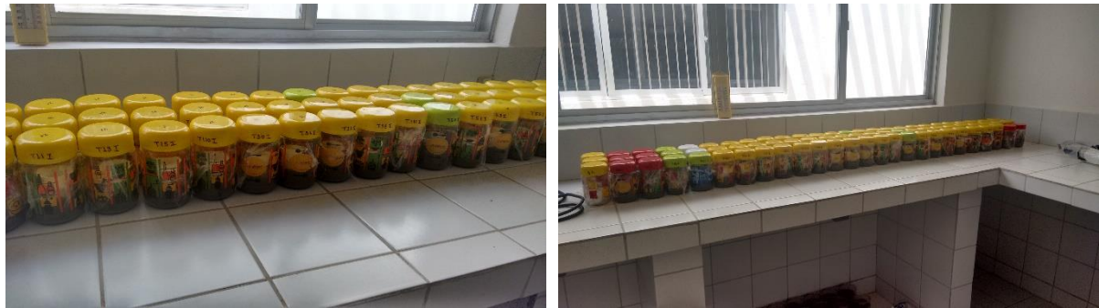
Figura 9. Frascos de vidro lacrados com filme PVC, hermeticamente fechados com tampa (respirômetros de Bartha adaptados).
